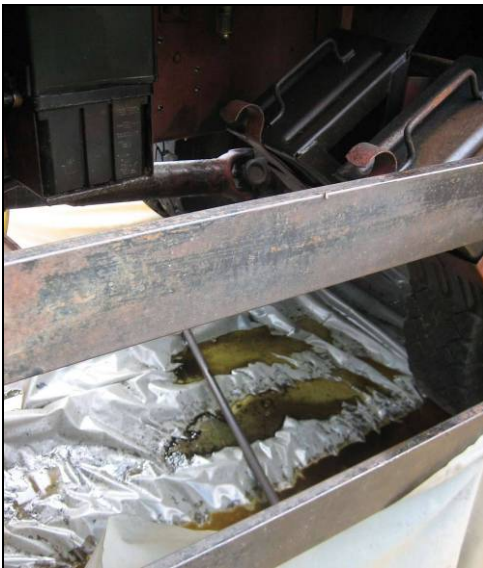
Abbildung 5-17: Verschmutzung von Grundstücken durch das Austreten wassergefährdender Stoffe (Maschinenöl) durch das Bohrgerät (Quelle TLUG).
